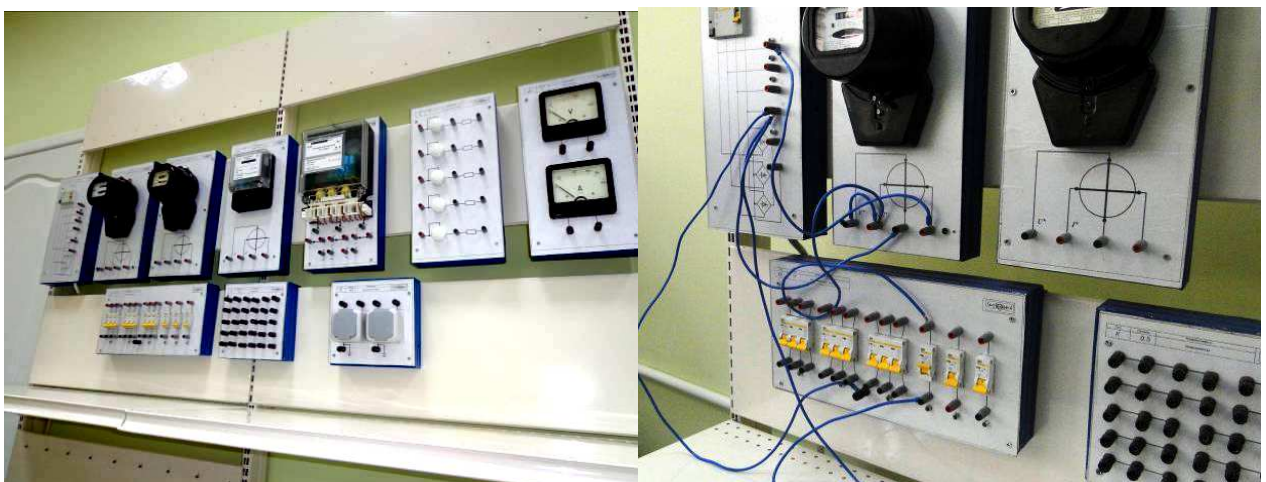
Рис. 2.22. Зовнішній вигляд навчального тренажеру до лабораторної роботи «Вивчення і знешкодження схем крадіжки електроенергії»
