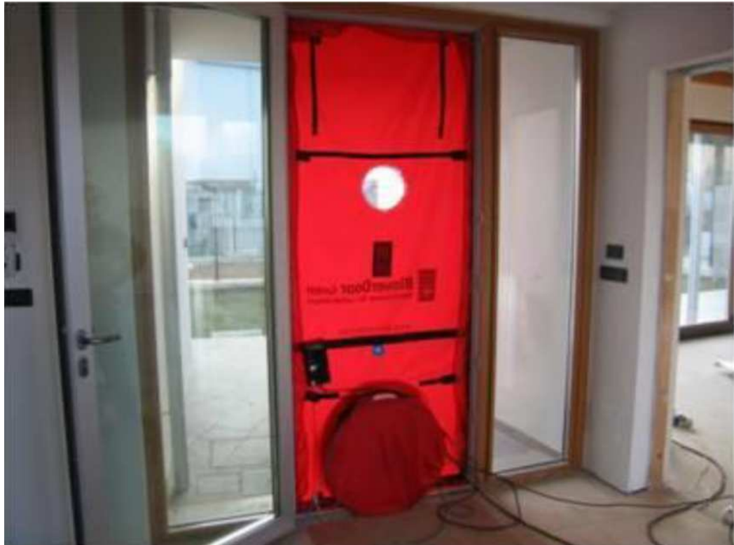
Рис. 2.17. Діагностика приміщення на герметичність
