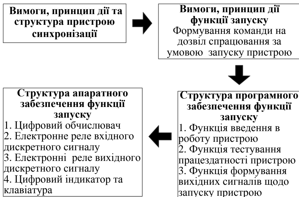
Рис. Б.4. Засіб каузального формування знань з визначення вимог щодо проектування, принципу дії та структури програмного й апаратного забезпечення функції запуску пристрою синхронізації
