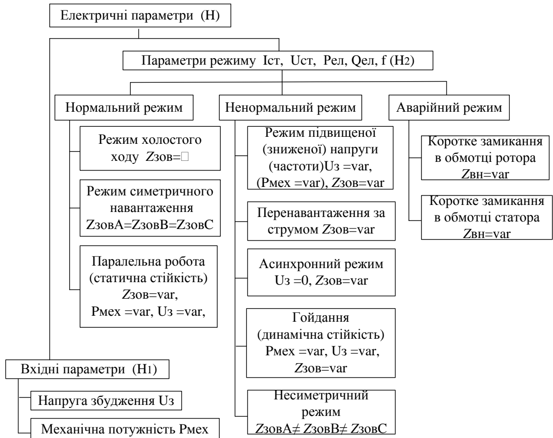
Рис. 3.58. Структура підсистеми Н синхронного генератора:
