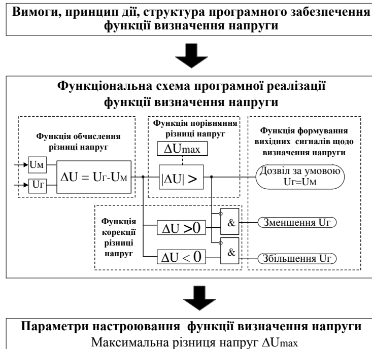
Рис. Б.9. Засіб каузального формування знань з визначення функціональної схеми програмної реалізації та параметрів настроювання функції визначення напруги пристрою синхронізації
