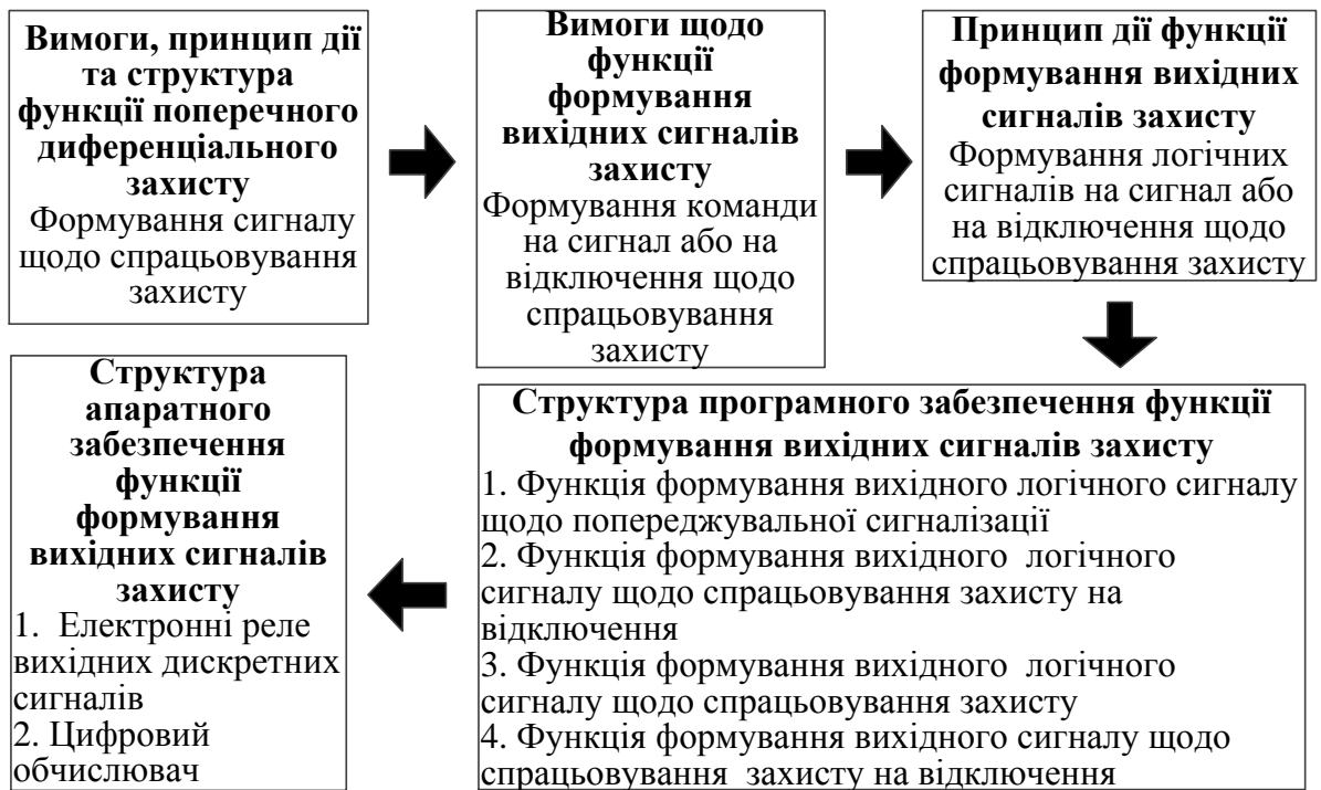
Рис. 4.46. Засіб каузального формування знань з визначення вимог, принципу дії й структури програмного та апаратного забезпечення функції формування вихідних сигналів захисту
