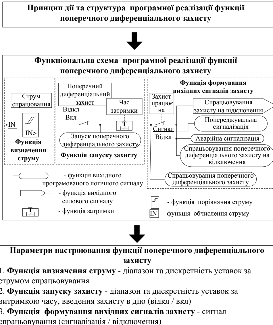
Рис. 4.47. Засіб каузального формування знань з визначення функціональної схеми програмної реалізації та параметрів настроювання функції поперечного диференціального захисту системи релейного захисту синхронного генератора
