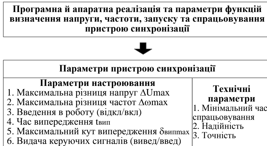
Рис. Б.13. Засіб каузального формування знань з визначення параметрів пристрою синхронізації
