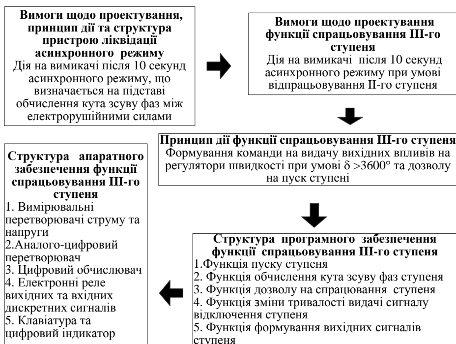
Рис. Б.19. Засіб каузального формування знань з визначення вимог щодо проектування, принципу дії й структури програмного та апаратного забезпечення функції спрацьовування III-го ступеня пристрою
