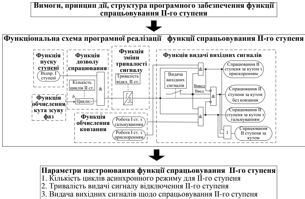
Рис. Б.21. Засіб каузального формування знань з визначення функціональної схеми програмної реалізації та параметрів налаштування функції спрацювання II-го ступеня пристрою ліквідації асинхронного режиму
