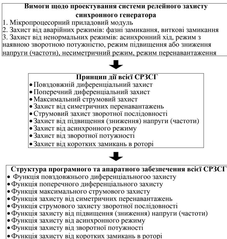
Рис. 4.42. Засіб каузального формування знань з визначення принципу дії й структури програмного та апаратного забезпечення всієї системи релейного захисту синхронного генератора
