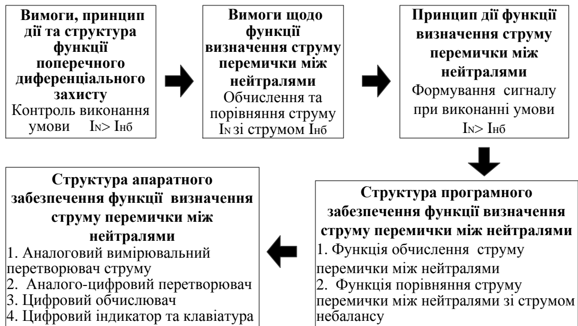
Рис. 4.44. Засіб каузального формування знань з визначення вимог, принципу дії та структури програмного й апаратного забезпечення функції визначення струму перемички між нейтралями
