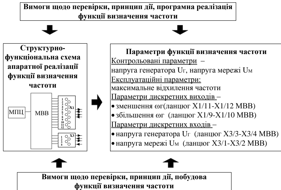
Рис. В.12. Засіб каузального формування знань з визначення параметрів функції визначення частоти пристрою синхронізації
