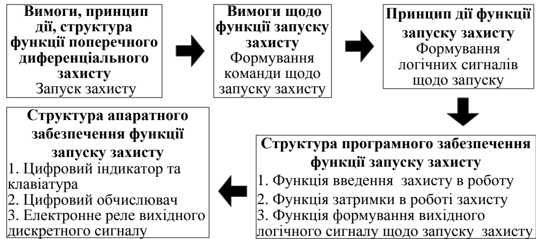
Рис. 4.45. Засіб каузального формування знань з визначення вимог, принципу дії й структури програмного та апаратного забезпечення функції запуску захисту
