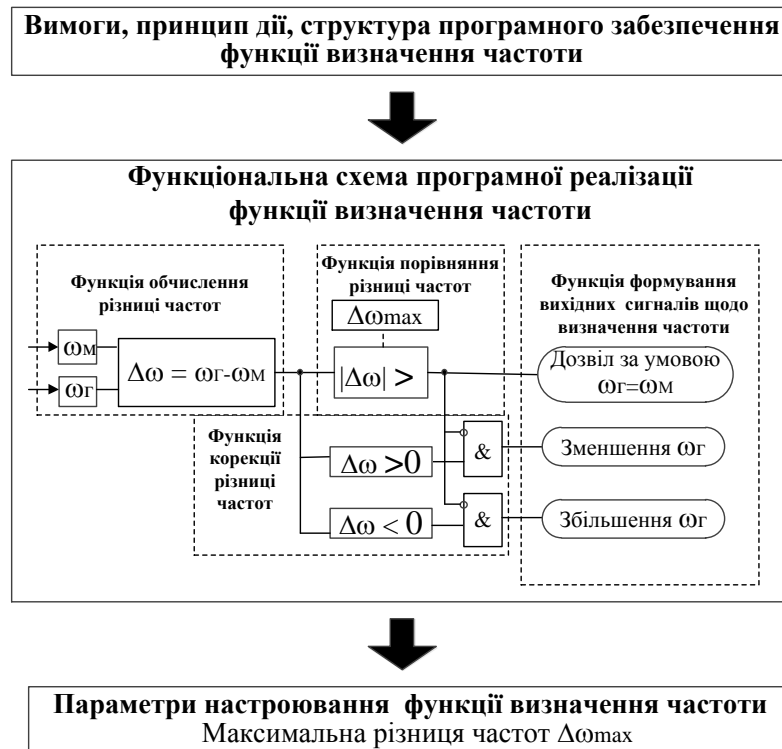
Рис. Б.10. Засіб каузального формування знань з визначення функціональної схеми програмної реалізації та параметрів настроювання функції визначення частоти пристрою синхронізації
