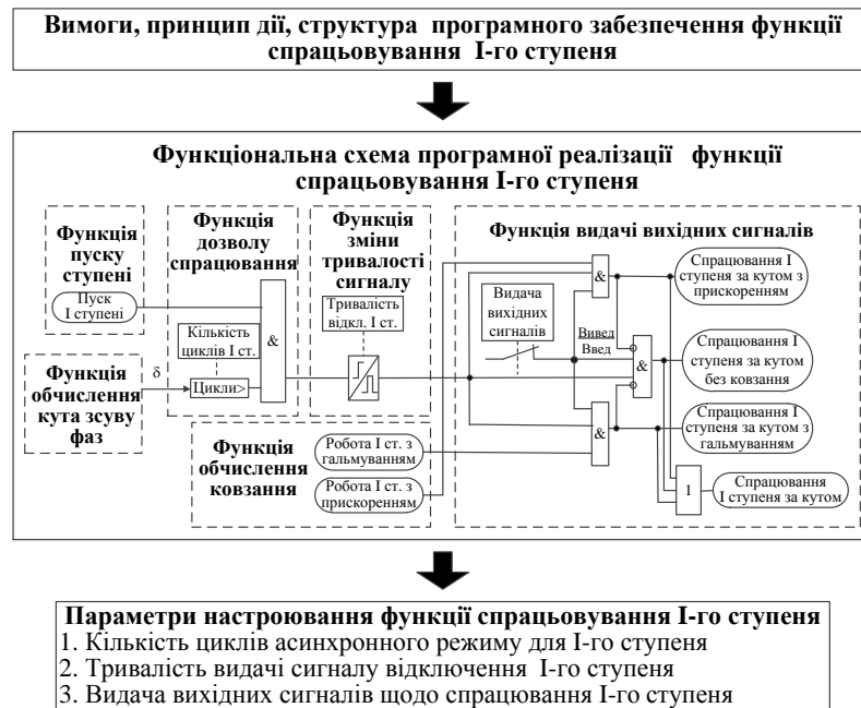
Рис. Б.20. Засіб каузального формування знань з визначення функціональної схеми програмної реалізації та параметрів настроювання функції спрацьовування I-го ступеня пристрою ліквідації асинхронного режиму
