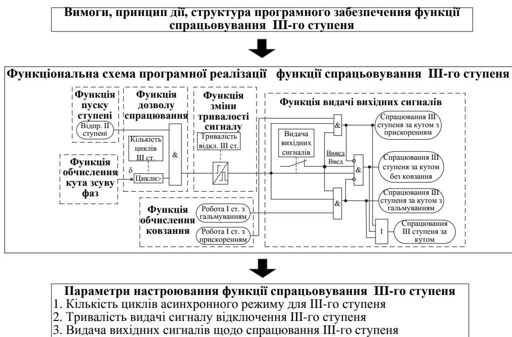
Рис. Б.22. Засіб каузального формування знань з визначення функціональної схеми програмної реалізації та параметрів налаштування функції спрацювання III-го ступеня пристрою ліквідації асинхронного режиму
