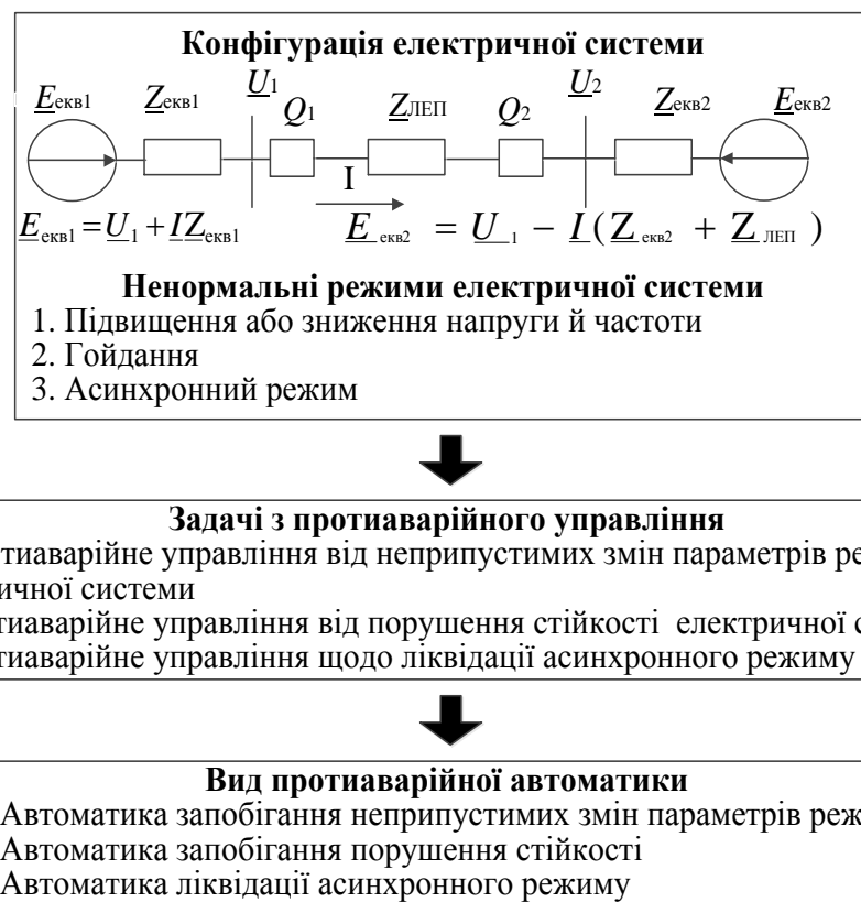
Рис. Б.14. Засіб каузального формування знань з визначення задач та виду протиаварійної автоматики електричної системи
