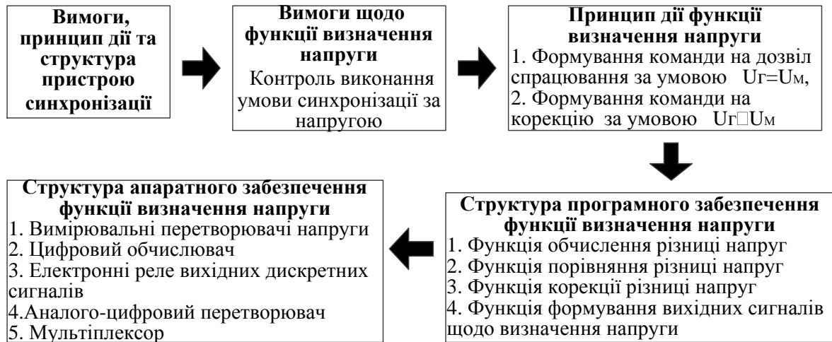
Рис. Б.5. Засіб каузального формування знань з визначення вимог щодо проектування, принципу дії й структури програмного та апаратного забезпечення функції визначення напруги пристрою синхронізації
