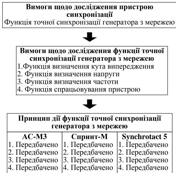
Рис. Г.4. Засіб каузального формування знань з визначення вимог щодо дослідження та принципу дії функції точної синхронізації генератора з мережею в пристроях АС-МЗ, Спринт-М, Synchrotact 5
