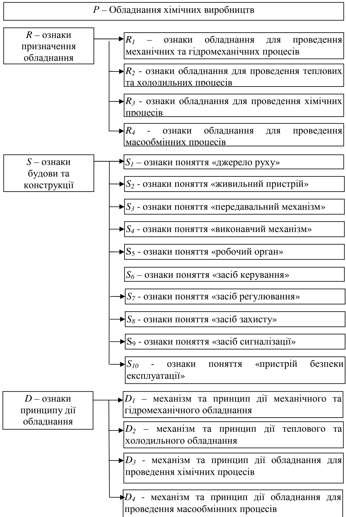
Рис. 2.13. Концептуальна структура поняття «Обладнання хімічних виробництв» за ознаками призначення, будови та принципу дії
